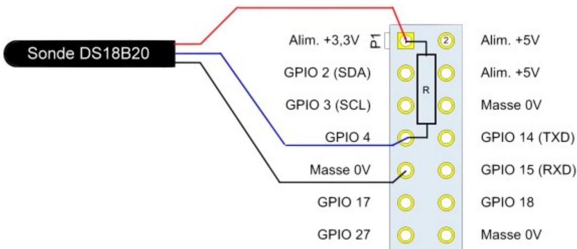
Raccordement entre la masse (PIN 6 ou bien PIN 9) et le +3,3V (PIN 1) du raspberry. Dans notre cas utilisation du port GPIO 4 sur la PIN 7. Une résistance de 4,7 kΩ est à insérer entre le +3,3V (PIN 1) et le GPIO utilisé (PIN 7 dans notre cas).
